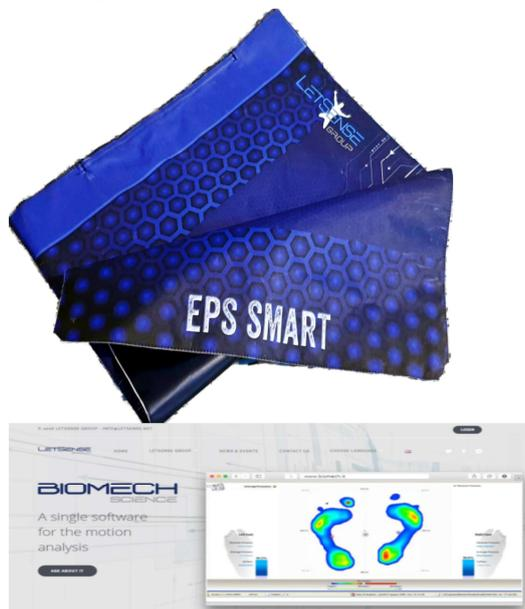
Versione INNOVATIVA, UNICA, SOTTILE ed estremamente FLESSIBILE della pedana baropodometrica resistiva SMART EPS/R2, con collegamento tramite WIFI e alimentazione a BATTERIE.
